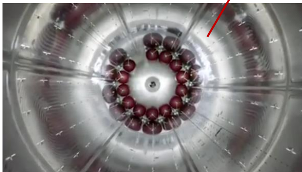
Гладкие обечайки бака кислорода
